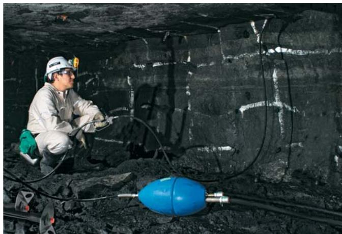
**X-Pandabolt** – анкер, внешне очень похожий на анкер Hydrobolt, но отличается тем, что после его установки вода вытекает. Это позволяет лучше подстраиваться под сдвиги породы, в которой он был установлен.
